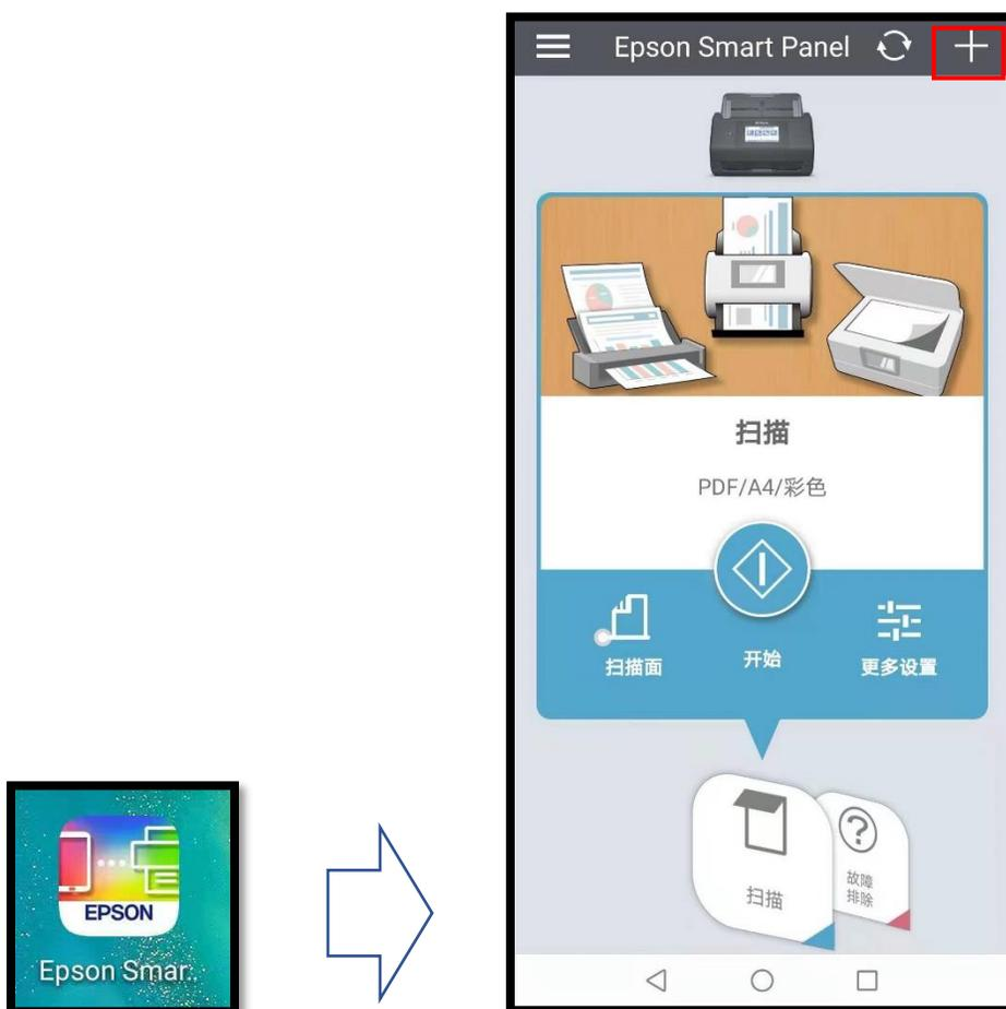
Step3: 点击主界面右上角的“+”（如上图所示）后，点击下图所示的“将智能手机连接到已连接到 Wi-Fi 的产品”按钮，并选择并点击要添加的扫描仪。
