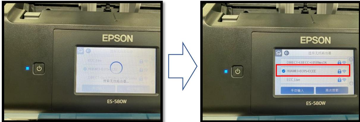
点击下图所示区域，输入无线局域网密码，并单击右下方的“确定”按钮。
